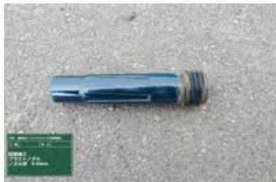
ブラストノズル (ノズル径 9.5 mm)
